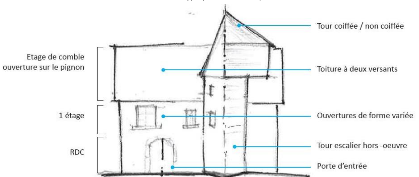
Elévation type (Source : CAPLA)
