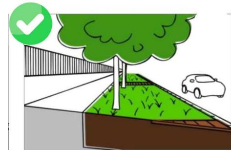
Exemple de prise en compte de la trame brune au niveau des alignements d'arbres. Source UPGÉ, 2022
